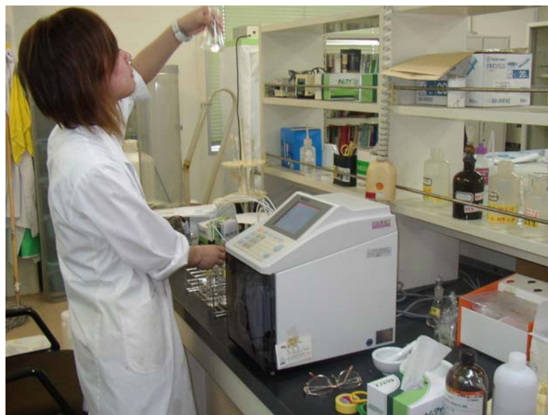
図2 土壌中の重金属成分の分析 上：蛍光X線分光分析装置 下：高感度水銀メータ
