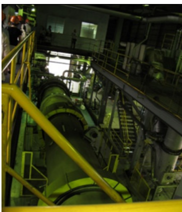
図1 使用済み乾電池リサイクルシステムのロータリーキルン炉図
