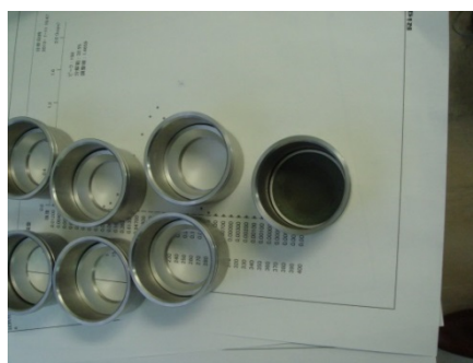
図 2 試料ホルダーおよび測定テーブル
