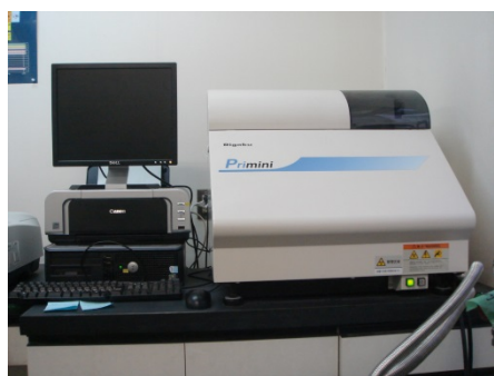
図 1 蛍光 X 線分光分析装置 (環境管理センター分析室設置)
