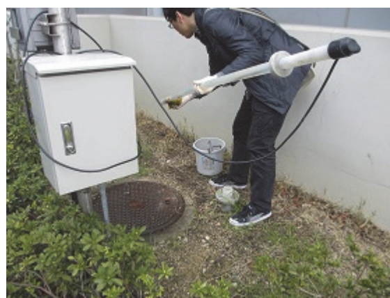
図2 pH電極メンテナンスの様子 センサー部分の洗浄
