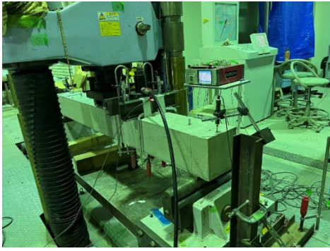
図3 曲げ荷重試験の様子(No.4 荷重時)
