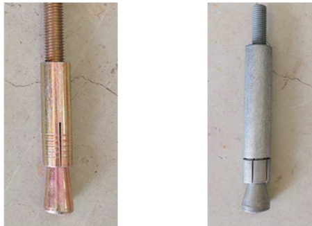
(a) 金属拡張アンカー (b) 金属拡底アンカー 図-4 使用した金属系アンカー
