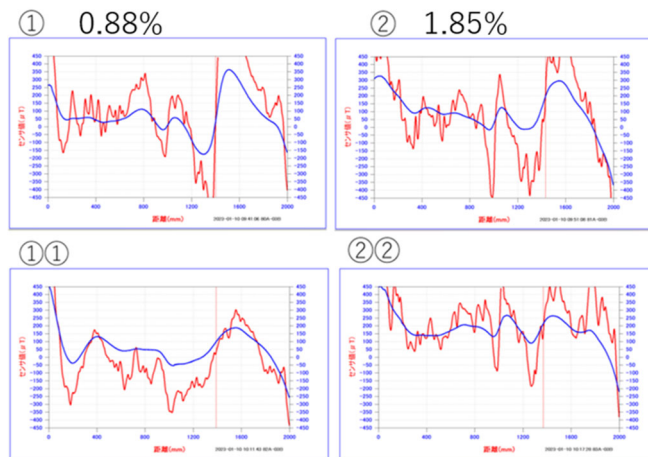
図-1 鋼繊維量・かぶりによる比較
