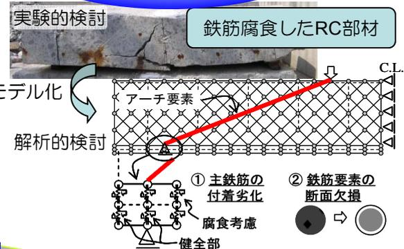
鉄筋腐食したRC部材の性能を評価します。特に、鉄筋とコンクリートの付着特性が部材の耐荷機構に与える影響について、実験的、解析的に検討します。
