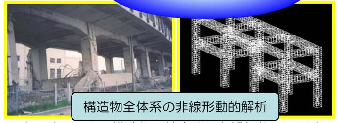
過去の地震による構造物の被害状況を解析的に再現することによって、地震時のRC構造物の挙動を予測します。また、非線形動的解析によって、構造物の耐震性能を評価します。
