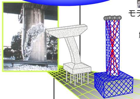
RC構造部材の非線形挙動を解析モデルを用いて予測します。
