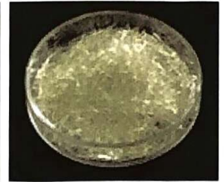
鋼繊維 (長さ15mm, 直径0.2mm, 引張強度2700N/mm 2 以上)
