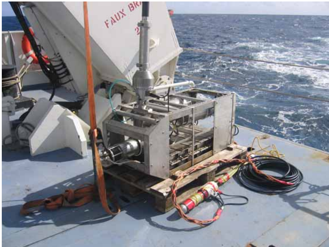
Figure 1 : Le magnétomètre deep two est constitué (1) d'un lest instrumenté, au fond, sur lequel sont fixés des lingots de plomb fondus dans des containers inox fermés (~600 kg), un profondimètre, deux caissons d'acquisition et de transmission, une balise de positionnement BUC Posidonia, et l'émerillon du câble SAR et son surpresseur, et (2) d'un poisson, devant, tracté 30 m derrière ce lest, qui contient le capteur (magnétomètre vectoriel fluxgate APS)
