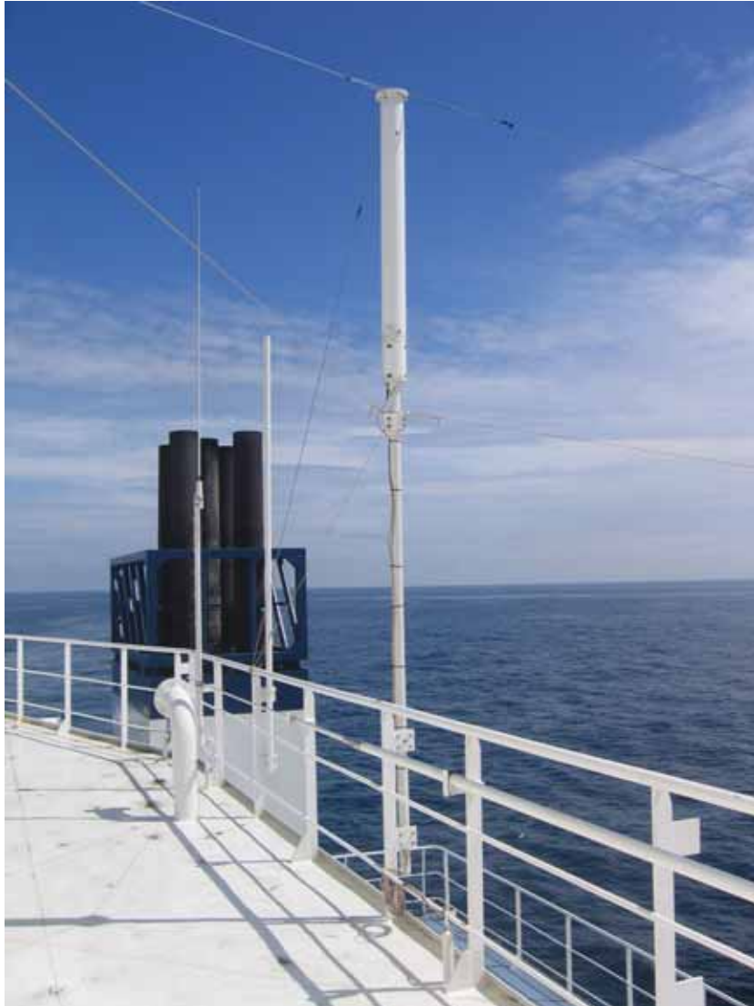
Figure 2 : Capteur du magnétomètre vectoriel de bord, sur le pont supérieur du navire.
