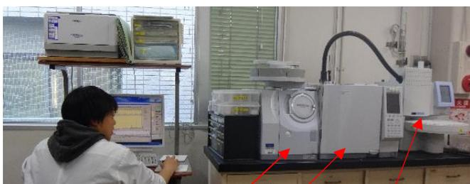
図 1 GC-MS 装置 MS 部 GC 部 試料導入部(HS 法)
