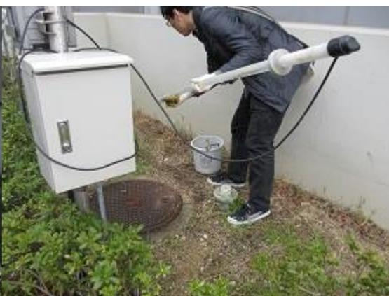
図 2 pH 電極メンテナンスの様子
