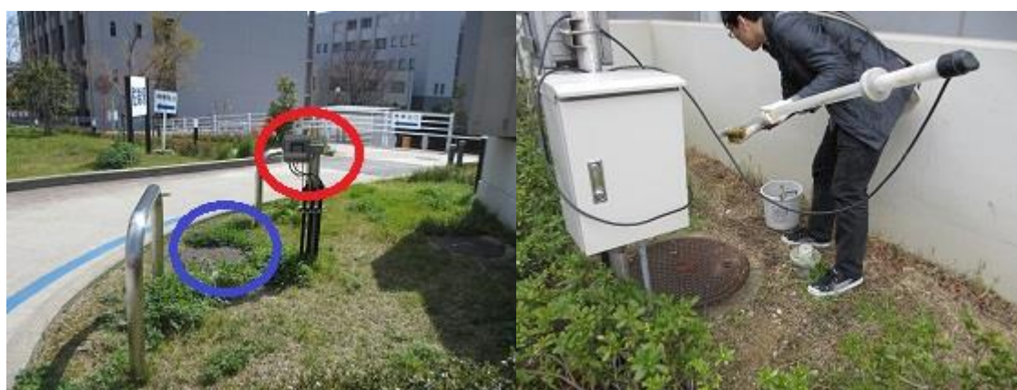
図2 pH電極メンテナンスの様子 センサー部分の洗浄を行っている。
