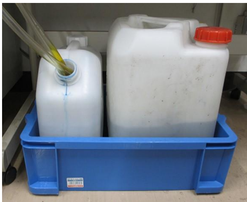
写真 廃液タンクに設置したトレイ
