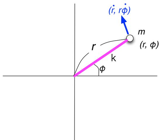
調和振動子系を考える。極座標  $(r, \phi)$  をとる。力は原点に向かう方向で、原点からの距離  $r$  に比例する。ポテンシャルは
