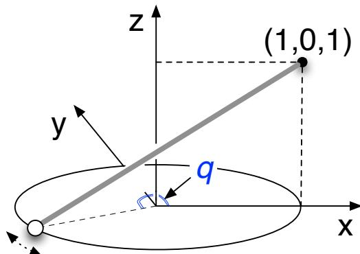
質量  $m$  の質点が、原点を中心とする半径 1 の円 ( $x^2 + y^2 = 1$ ) の上を滑る。この質点が、点  $(x, y, z) = (1, 0, 1)$  とバネでつながれているときの運動を求める。重力はなく、摩擦は無視する。バネ定数は  $k$ 、自然長は 0 とする。
