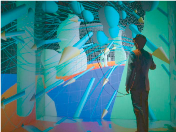
図1 VFIVE による流れ場の解析(矢印と流線追跡機能)
