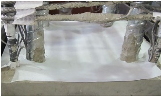
写真 3-3 打継ぎ部での付着抑制
