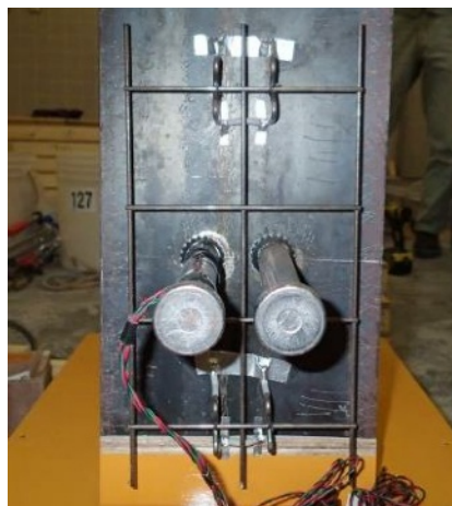
写真 6.2 溶接金網設置状況
