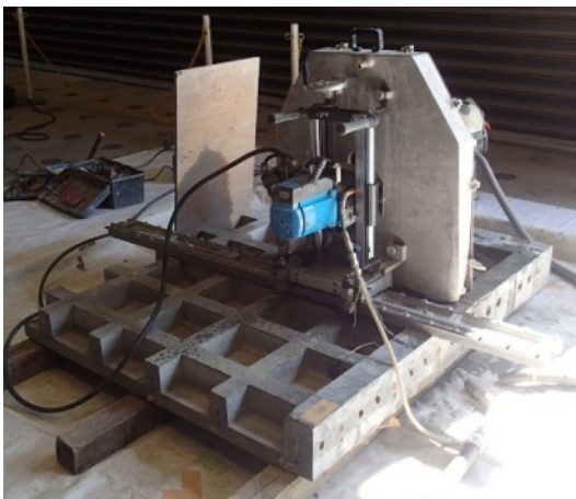
(a) 輪荷重走行試験の試験体から切り出し
