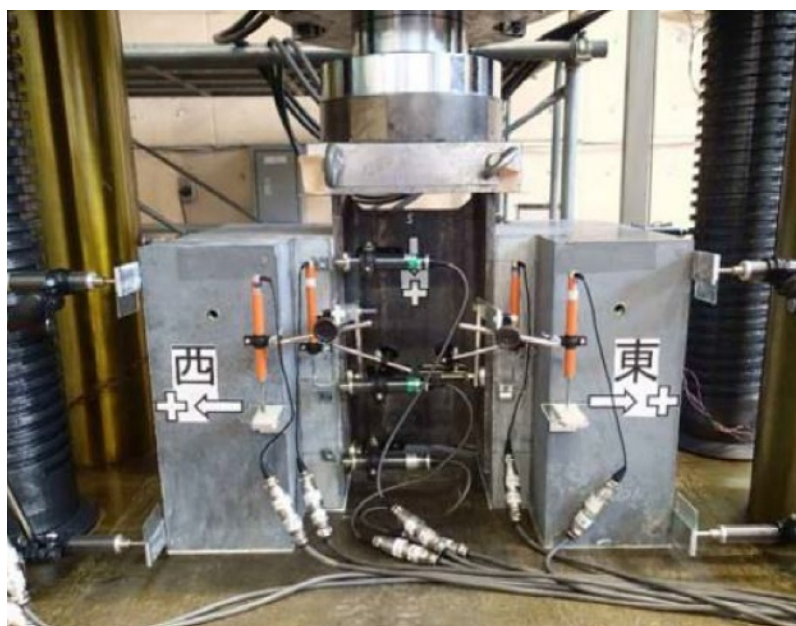
写真 6.3 押抜き载荷試験状況
