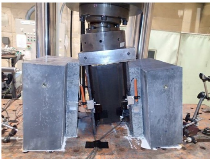
写真 6.5 試験体の疲労破壊状況（試験体 No. 8）
