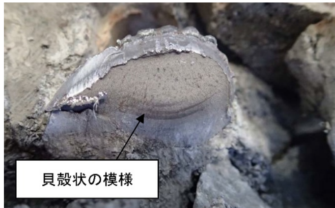
写真 6.7 スタッドの破断面 (試験体 No. 10)
