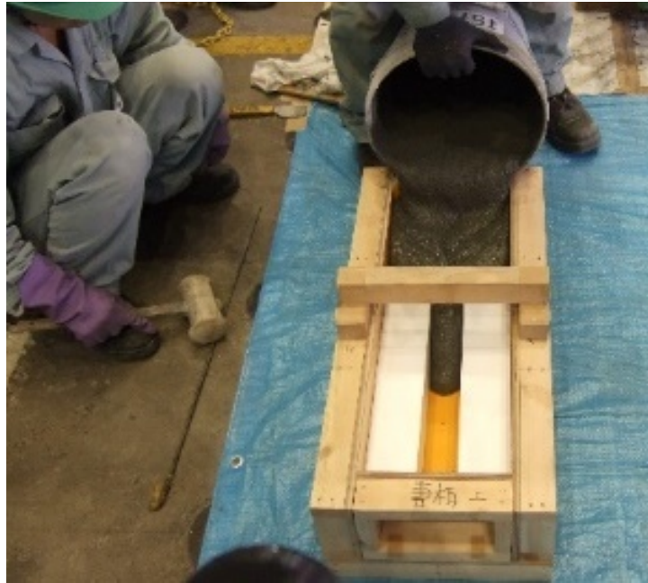
写真 4.6 直接引張試験用の UFC 梁部材の打設状況
