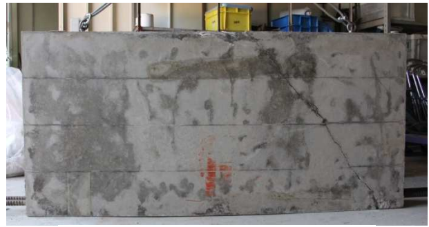
写真-2 破壊後の様子 (N1.0-750)
