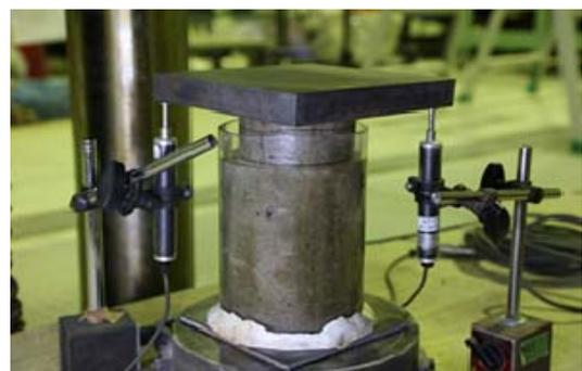
図-1 低サイクル圧縮疲労試験の様子
