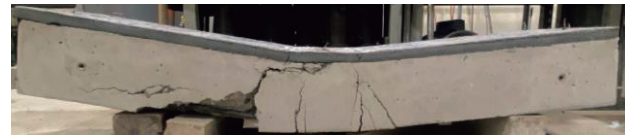
図-11 B-20 載荷試験後の様子
