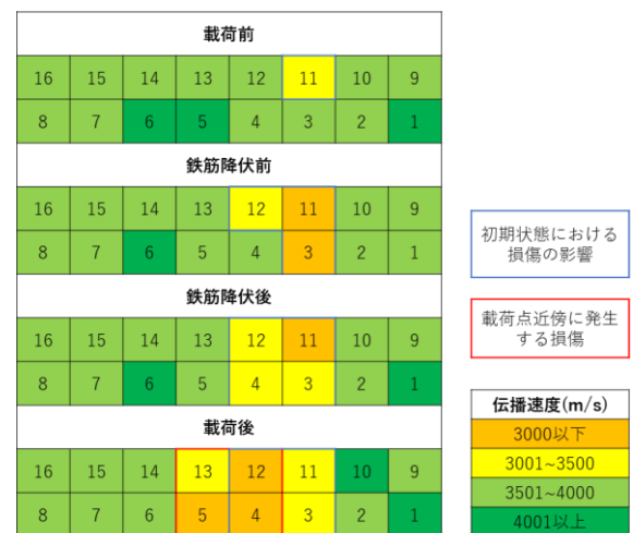
図 1. 各荷重段階における超音波試験結果
