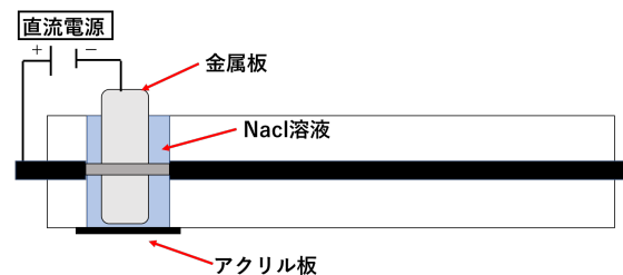
図 2 腐食実験概要
