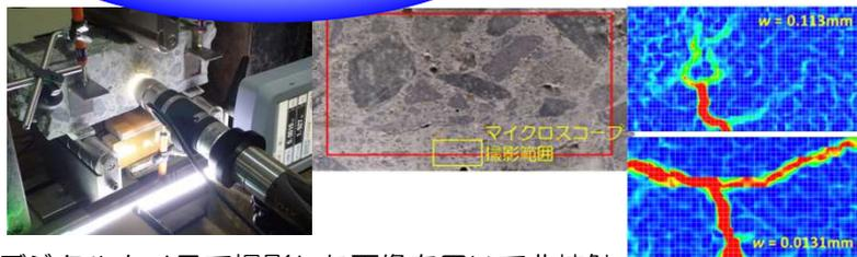
デジタルカメラで撮影した画像を用いて非接触かつ広域にひずみ計測します。ひび割れ発生後のRC部材の耐荷機構の変化を評価します。
