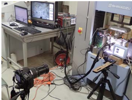
荷重試験の様子 (高画質デジタルカメラと マイクロスコップを用いて観察します)
