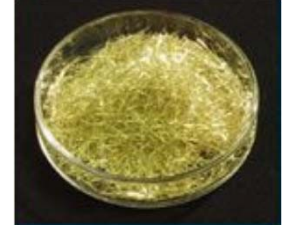
鋼繊維 (長さ15mm, 直径0.2mm, 引張強度 2700N/mm²以上)
