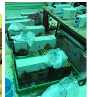
鉄筋腐食促進試験
