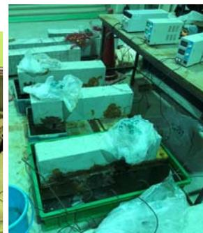
鉄筋腐食促進試験
