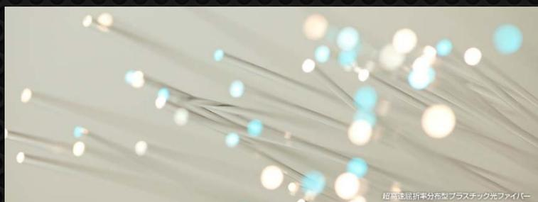
超高度屈折率分布型プラスチック光ファイバー
