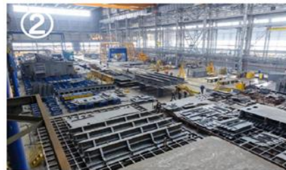
クレーン横の溶接用室内組み立てライン
