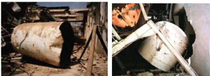
飛翔したタンクの前方部（左）と後方部
