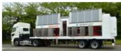
高圧水素トレーラー
