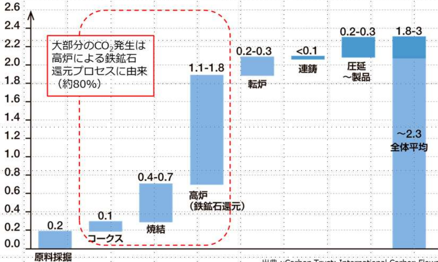
鉄鋼製造プロセスからのCO 2 発生比率 (t-CO 2 /t-粗鋼)
