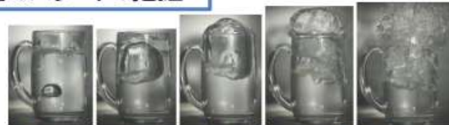
リスクの一例:急激な沸騰泡の形成(突沸) (上図は真水の例)
