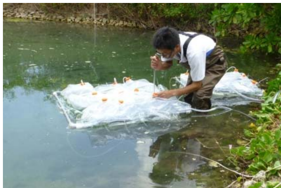
水面を活用した藻類バイオマス生産実験 Algal biomass production using a floating cultivation system.
