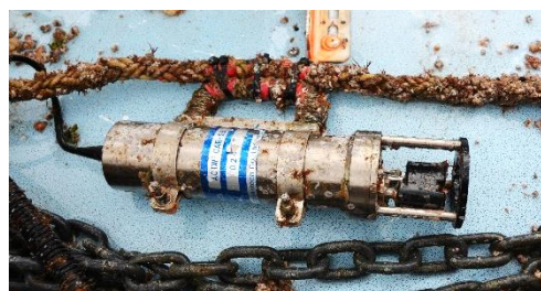
図2 ワイパー式メモリー水温塩分計 水深0.5mの水温と塩分を測定し、測定前にワイヤーでセンサー部を自動で掃除する。ケースはチタン製。
