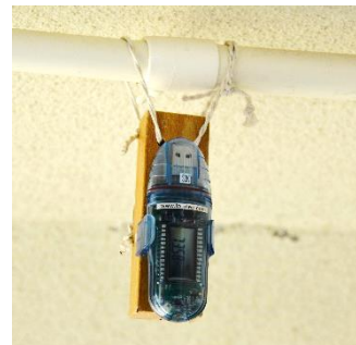
図 4 温湿度データロガー サイズ 110×39×30mm で 重量 45.5g。設定はパソコン に接続して行う。
