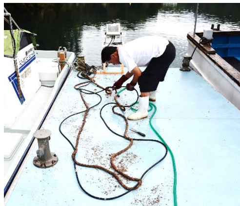
図 5 センサー部の清掃の様子 清掃は測定直後に行い、次の測定に影響 の無いよう素早く行っている。
