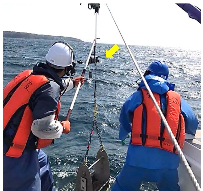
図 2. メッセンジャー方式 (矢印: アタッチメント)
