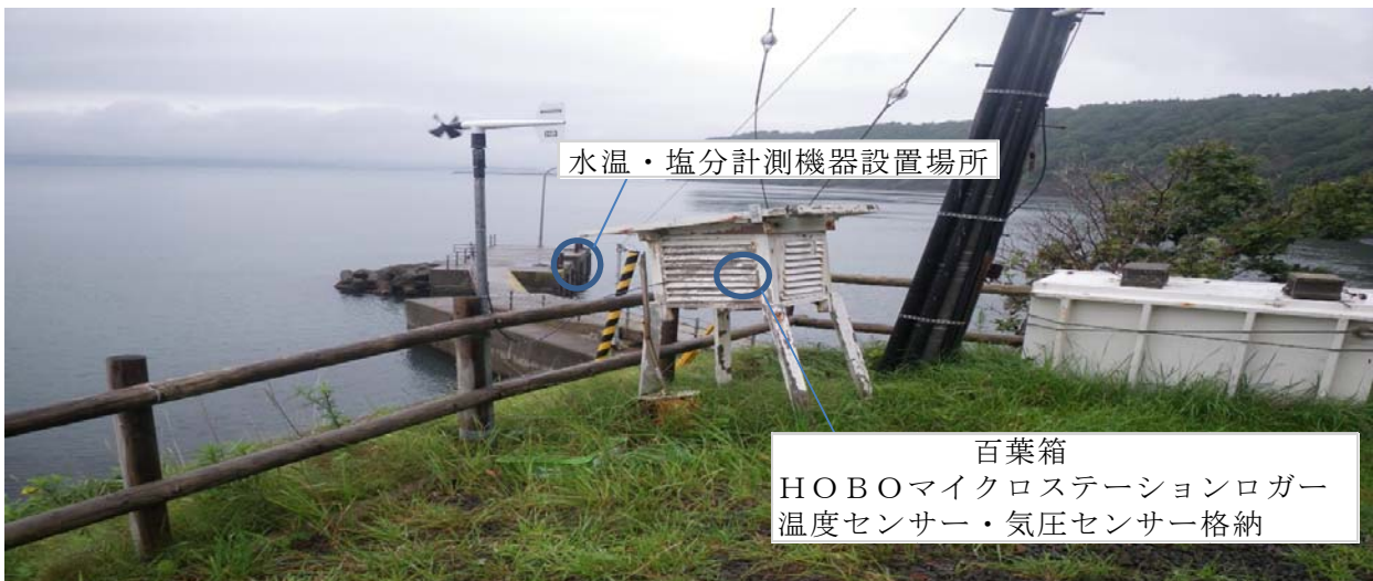
気象観測機器設置場所
