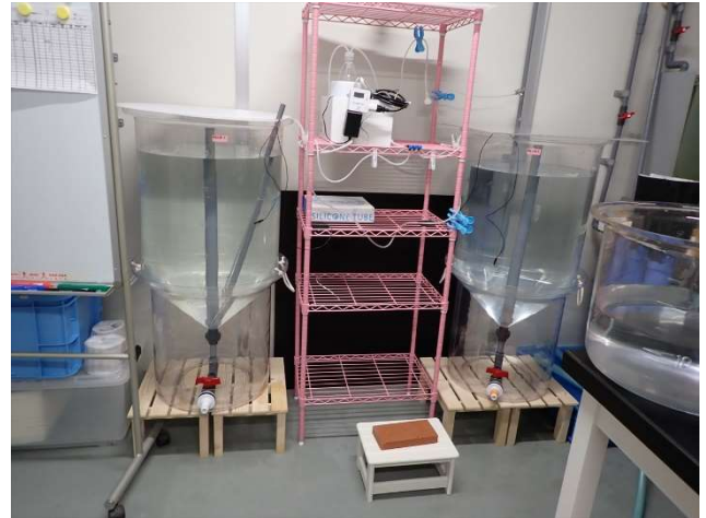
図1. アコヤガイ幼生の飼育の様子・中央のピンクのラックに自動給餌器を設置し、左右両側に幼生飼育用の水槽が置かれている。
