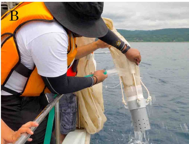
図 2. ニューストンネットで用いられた海水ポンプ。 A: 海水ホースと海水ポンプ. B: 使用時の様子.
