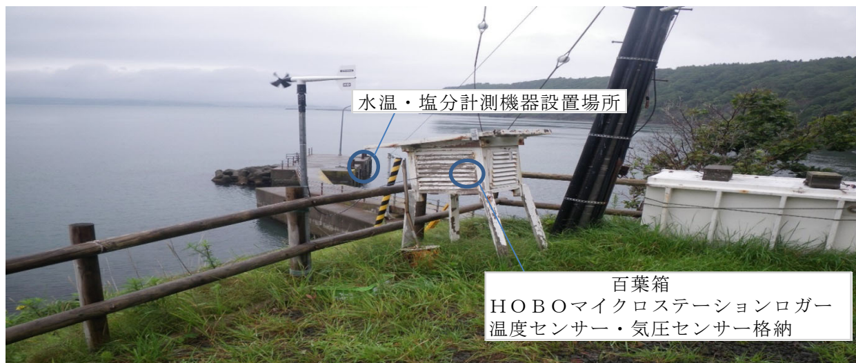
気象観測機器設置場所
