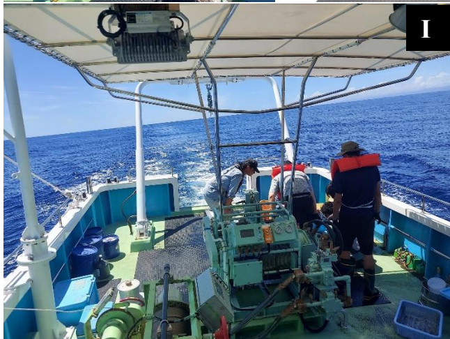
F 油圧可動式 A フレーム（ウィンチ操作部で操作） G 後方舷門 H 主機（調査室の床下がエンジンルーム）
