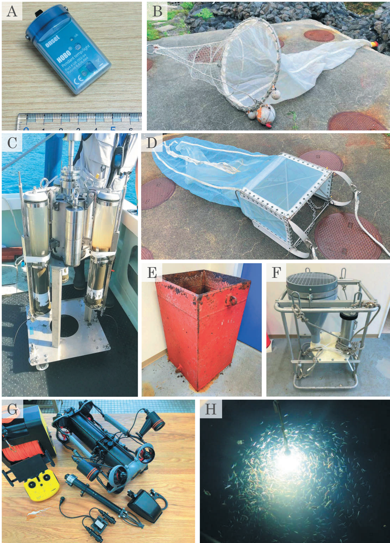
図 1 臨海実験施設で所有する海洋観測サンプリング機器。A: 水温・照度データロガー。B: 稚魚ネット。C: G.S.型表層採泥器（アシュラ）。D: ソリネット。E: 縦型ドレッジ。F: セグメントトラップ。G: 水中ドローン。H: LED 集魚灯。
