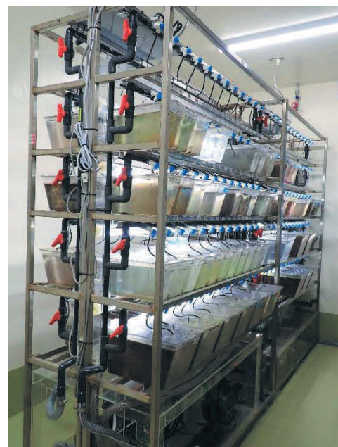
写真 1. 小型魚類用循環水槽システム
